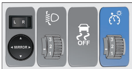
شکل (۲) دکمه تنظیم روشنایی صفحه کیلومترشمار
