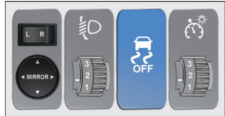
شکل (۵) دکمه فعال/غیرفعال کردن سیستم ESC
