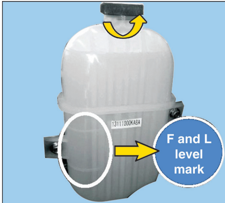
شکل (۱۴۵) خط نمایشگر سطح مایع خنک کننده در مخزن آب رادیاتور
