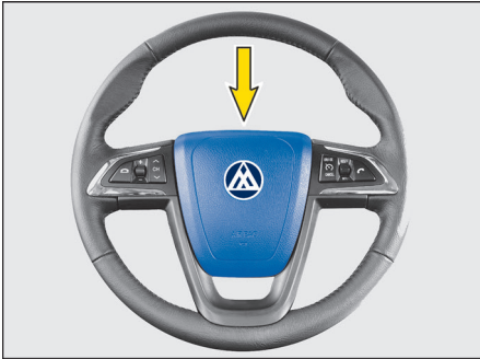
شکل (۱۲۸) محل قرار گیری کیسه هوای راننده داخل غربیلک فرمان
