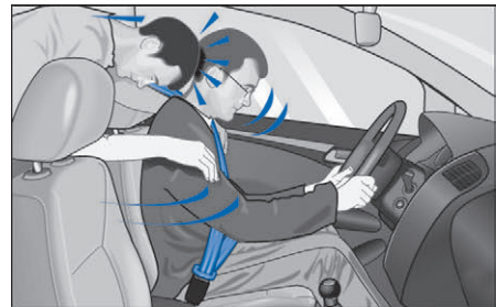
شکل (۱۲۱) سرنشینی که کمربند ایمنی او باز باشد، به جلو پرتاب خواهد شد.
