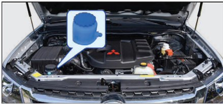
شکل (۱۳۴) موقعیت قرارگیری مخزن روغن سیستم فرمان
