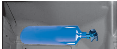
شکل (۱۵۱) کپسول اطفاء حریق
