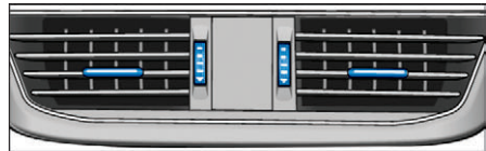
شکل (۹۲) تنظیم جهت هوای خروجی
