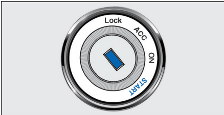
شکل (۹۷) وضعیت استارت زدن موتور
