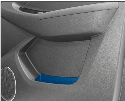
شکل (۷۴) تریم داخلی درب به همراه جعبه تعبیه شده در آن
