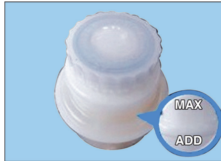
شکل (۱۴۶) خطوط شاخص روی مخزن روغن ترمز
