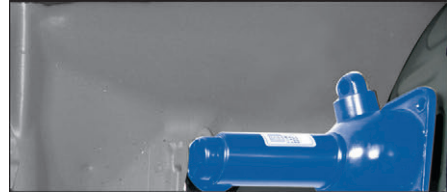
شکل (۱۵۳) محل قرار داشتن جک
