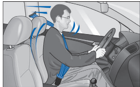
شکل (۱۱۷) کمربند ایمنی بدن راننده را در هنگام ترمز اضطراری مهار می‌کند.
